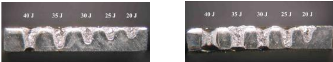
Obr.8 Typické prievary dosiahnuté pri impulzoch s dĺžkou 20 ms (vľavo) a 10 ms (vpravo) (pri fokusácii 51 mm, hrúbka materiálu 1,5 mm)
