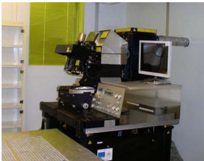
Obr. 21: Expozičné a súkrytovacie zariadenie vybavené modulom pre nanoimprint litografiu (NIL) firmy Süss Microtec MA6
