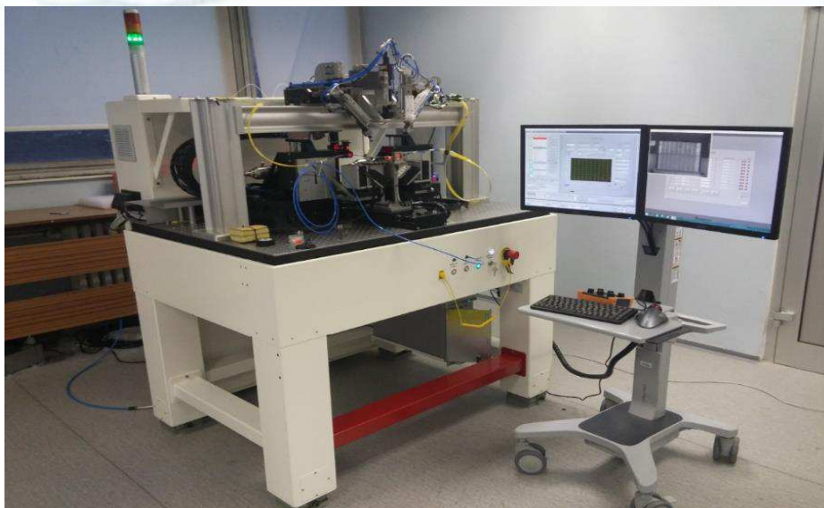
Obr. 1. Fotografia zariadenia pre vysoko presné polohovanie a skladanie optoelektronických súčiastok.
